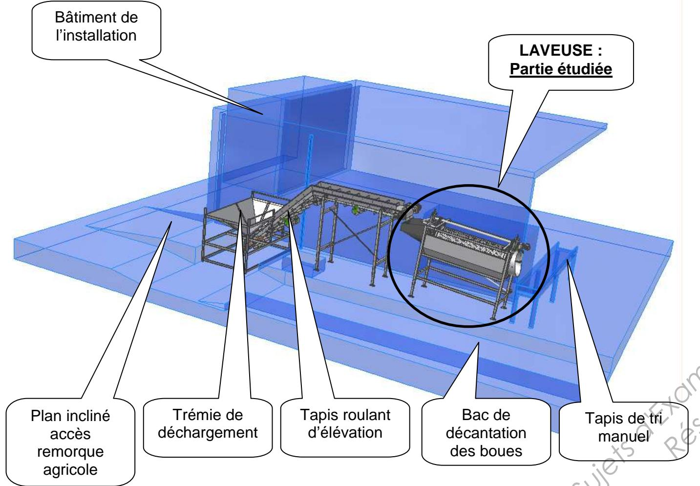
Les carottes arrivent à la station de lavage, en provenance de la zone de récolte, dans des remorques agricoles. Leur contenu est versé dans la trémie de déchargeement. Les carottes sont ensuite élevées par un tapis roulant incliné et tomberont dans la laveuse, pour en ressortir sur un tapis roulant horizontal, sur lequel du personnel sera chargé de trier et d'évacuer manuellement les mauvaises carottes.
