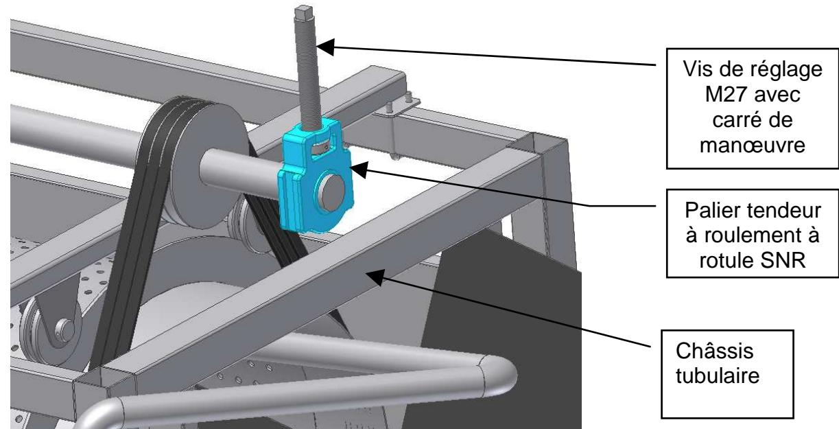
L'image ci-dessus montre le nouveau palier mis en place. Le travail demandé va consister à concevoir un support mécano-soudé en tôle d'épaisseur 5 mm.
